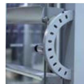
Orientación por indexación de 15°
